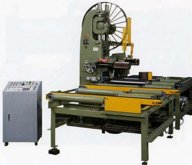
Основной целью разработки данного станка является повышение эффективности обработки и распиловки, а так же увеличение добавочной стоимости готового материала. Благодаря функции поднятия валиков стало возможной обработка горбыля с высокой точностью и скоростью. Управление станком и позиционирование осуществляется с помощью компьютера. Использование серводвигателя помогает достичь скорости и точности обработки древесины.
